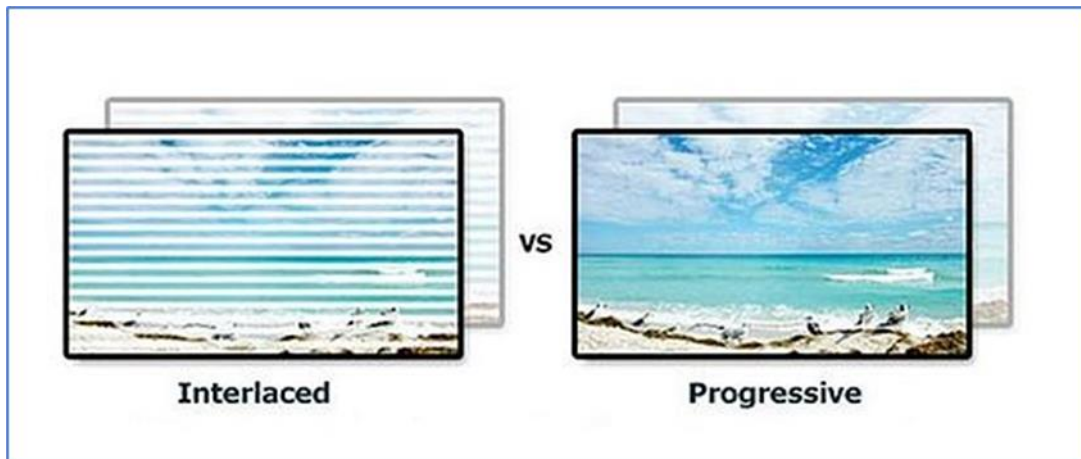
Figure 2-2 : le balayage de l'image : mode entrelacé – progressif
